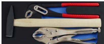
Wasserpumpenzange, Hammer, Gripzange
