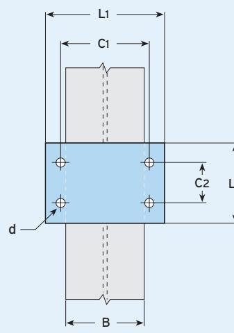
1) Je nach Lastart und Bauteilgeometrie muss die Kopfplatte statisch nachgewiesen und ggf. dicker ausgeführt werden.
