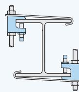
Bei der Montage von Rohren über DN 65 ist eine Sicherungslasche zu verwenden (Details anfragen). Diese Sicherungslasche wird generell bei geneigten Flanschen empfohlen, darüber hinaus bei geneigten und gekippten Trägern.
