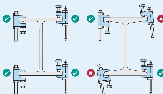
► Bei Schräglanschprofilen muss die Ringschneide der Schraube immer auf der geneigten Flanschseite greifen.
